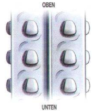
Die Noppen sind konisch geformt. Die schmale Seite zeigt nach oben
