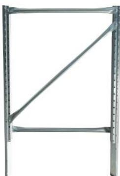
Optimal ist, wenn bereits in der Planung die stirnseitigen Rahmen um mindestens einen 1/2 Meter höher als die mittigen Regalrahmen ausgeführt werden. So ist die Einhaltung von BGR 234 4.2.4.2 sichergestellt. Aufsatzrahmen können nachträglich als seitlicher Schutz gegen Herabfallen von Ware nachgerüstet werden.
